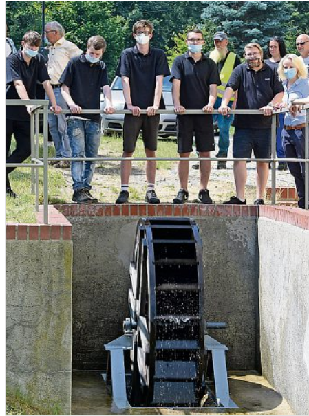
Das alte Wasserrad der Kirchmühle ist erneuert und zurück an seiner Wirkungsstätte, im Mühlgraben in Schönau-Berzdorf. Bis in die 1960er-Jahre war diese noch in Betrieb (links). Für das Wasserrad haben die Jugendlichen zuvor Modelle angefertigt, bevor das zwei Meter große Original aus Eichenholz unter fachlicher Anleitung des gelernten Zimmermanns Markus Kepstein entstand. Fotos: Matthias Weber
